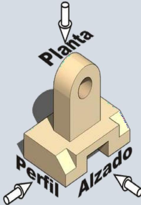
Las reglas a seguir para la representación de las vistas de un objeto, se recogen en la norma UNE 1-032-82, "Dibujos técnicos: Principios generales de representación", equivalente a la norma ISO 128-82
